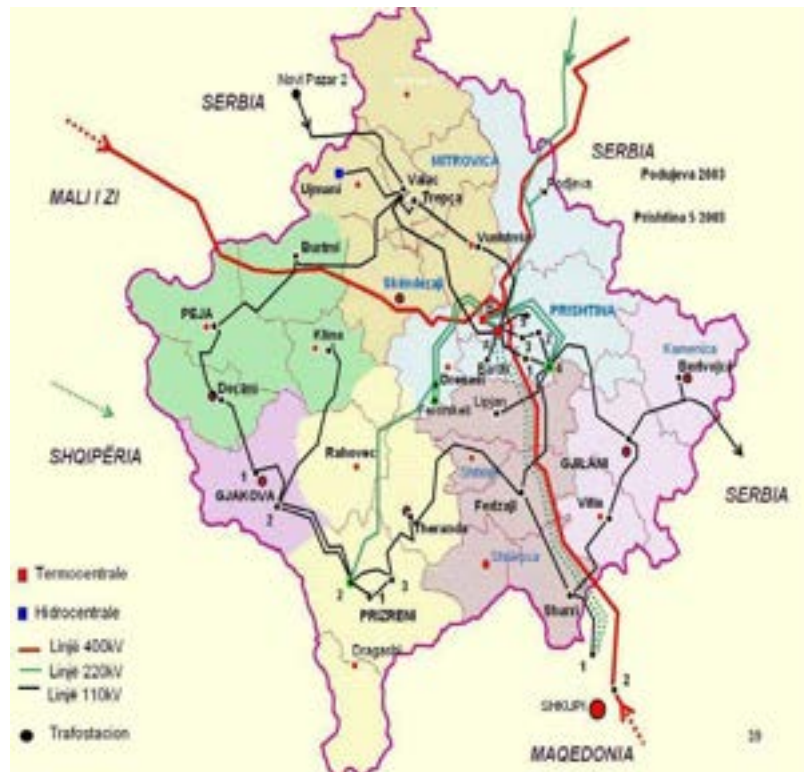
Figura 2 Skema njëpolare 400/220/110 kV në hartën geografike të Kosovës
