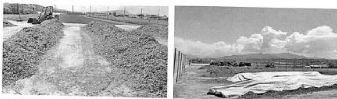
Figura 27. Një implant tipik kompostimi i vargjeve
