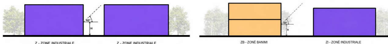
Figura 9 Shembulli i llogaritjes së lartësisë për bazuar në këndin 45°
