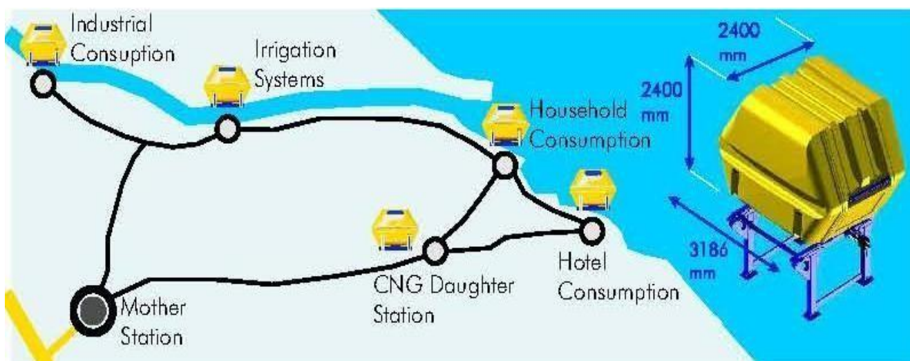
Figura 55 Skema e funksionimit të sistemit CNG-së
